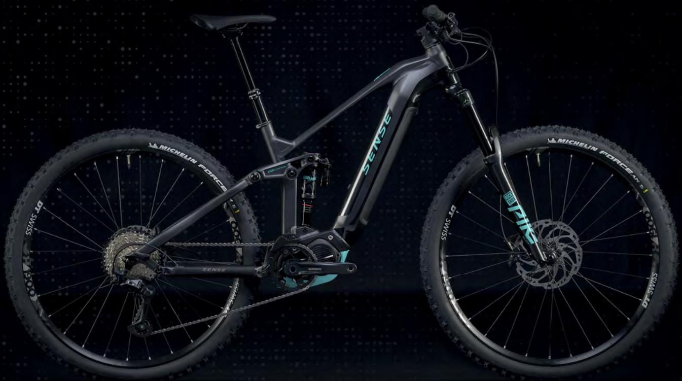
SHIMANO E8000 | 250W // BATERIA INTEGRADA AUTONOMIA DE ATÉ 130 KM // TRANSMISSÃO SHIMANO SLX 1X12V
